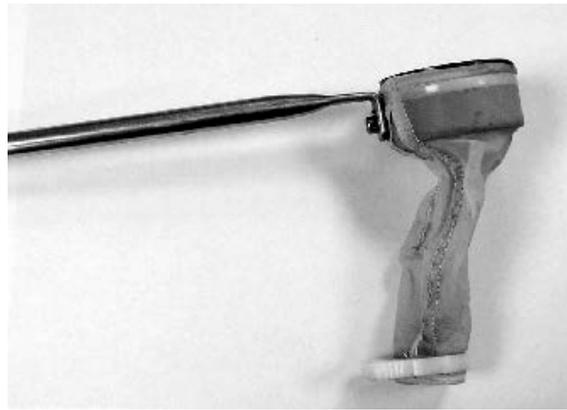
**Figura 4** - Esempio di campionatore per superfici artificiali verticali.
