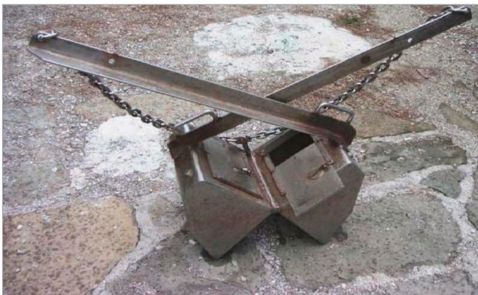
Figura 1 - Benna Van Veen con sportelli per ispezione del contenuto
