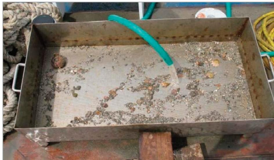
Figura 3 - Setacciatura del campione tramite lavaggio dello stesso nella vasca di raccolta
