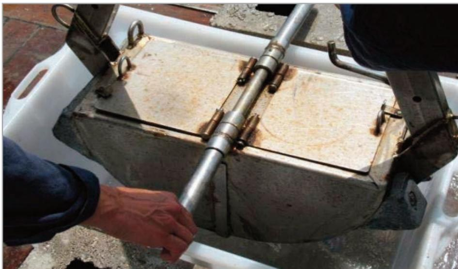
Figura 2 - Alloggiamento della benna chiusa nell'apposito vascone ed ispezione del contenuto della benna tramite gli appositi sportelli
