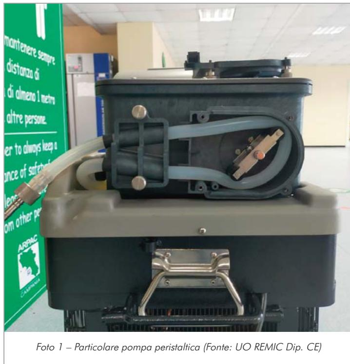
Foto 1 - Particolare pompa peristaltica (Fonte: UO REMIC Dip. CE)
