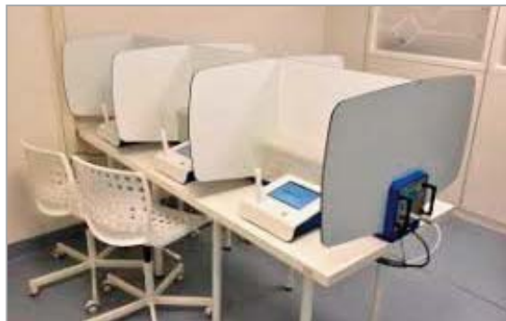
Foto 1: Olfattometro per la misura della concentrazione di odore mediante olfattometria dinamica, secondo la norma UNI EN 13725:2004. Lo strumento viene comandato da un apposito software, che regola le diluizioni e la presentazione dei campioni al panel.
