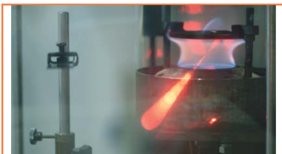
Misure di concentrazione di fuliggine mediante estinzione della luce laser in fiamma laminare premiscelata
