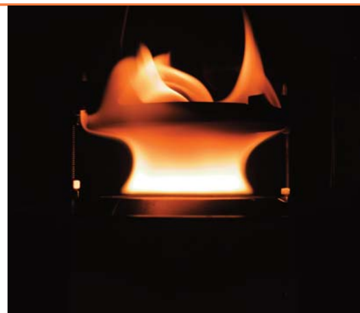
Fiamma laminare premiscelata ricca per la produzione massiva di fuliggine
