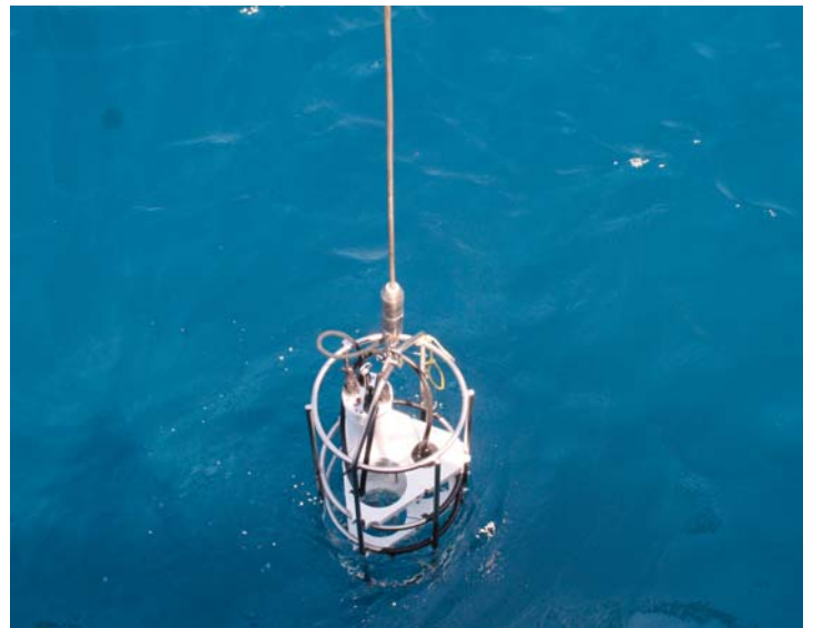
Sonda multiparametrica immersa in acqua in corrispondenza del punto di inizio del campionamento delle microplastiche, all'interno del Golfo di Napoli.
