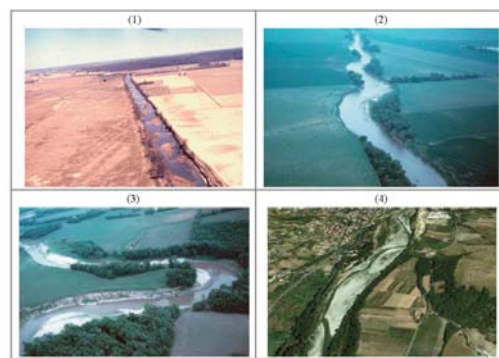
Figura A4.6 - Esempi di morfologie di alvei semiconfinati e non confinati. (1) Rettilineo, (2) Sinuoso, (3) Meandriforme, (4) Sinuoso a barre alternate.
