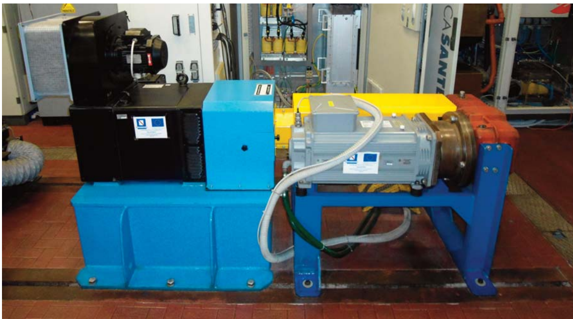
Banco di laboratorio dinamico per sistemi di accumulo ibrido e sistemi di propulsione. Negli armadi batterie e super-condensatori
