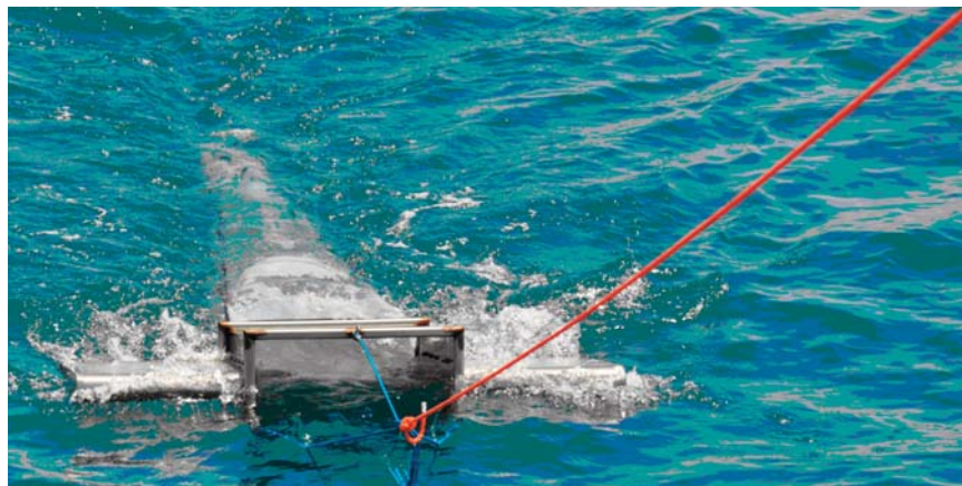
Retino di tipo "manta" per il campionamento delle microplastiche (foto Arpac)
