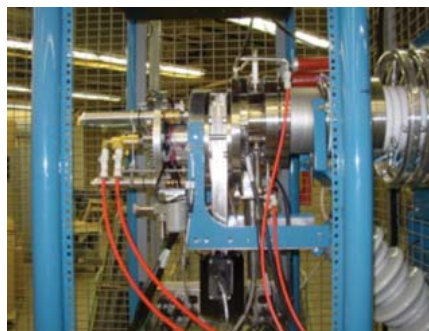
La sorgente di ioni dell'acceleratore CIRCE
