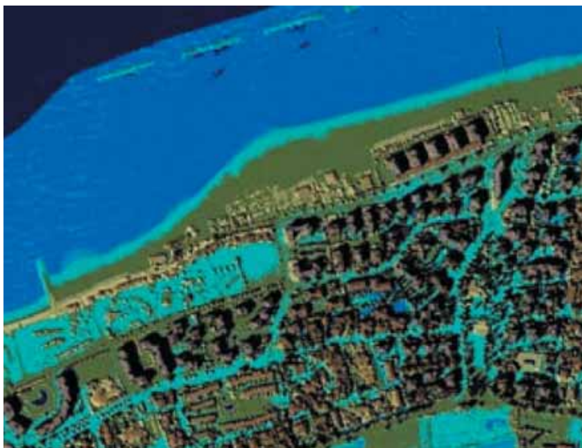
▲ Fig. 2 - Esempio di modello digitale di superficie (DSM) ottenuto con tecnica LIDAR (Light Detection and Ranging)
